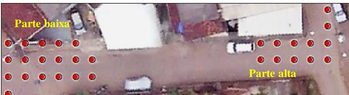
Figura 12: Erro de comissão. Pontos que pertencem ao terreno e que foram removidos pela ação da filtragem
