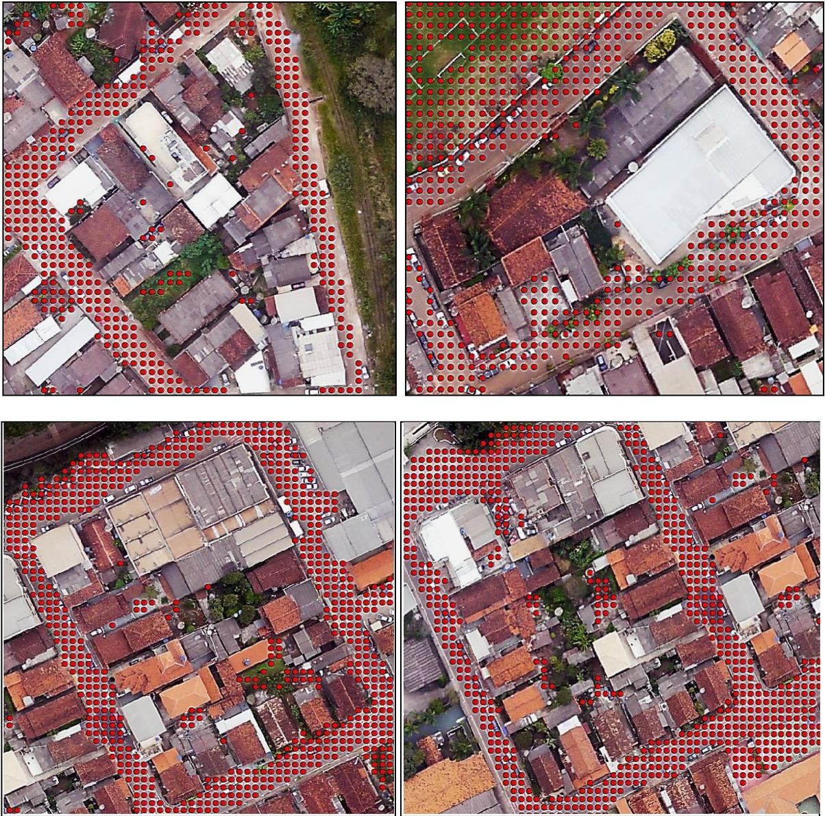
Figura 10: Resultado da filtragem. Os pontos na cor vermelha foram considerados pertencente ao terreno
