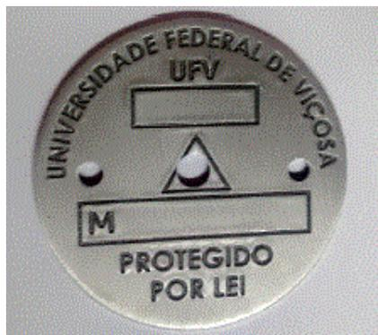
Figura 1 – Chapa para Identificação dos Marcos Geodésicos
